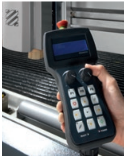
Console mobile avec écran tactile. L'interface graphique moderne et intuitive pour une gestion simple de la machine
